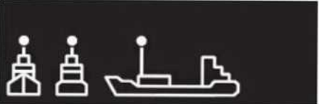
Figura 5.5 Nave a propulsione meccanica di lunghezza inferiore a 7 m e la cui velocità massima non superi i 7 nodi, in navigazione.
